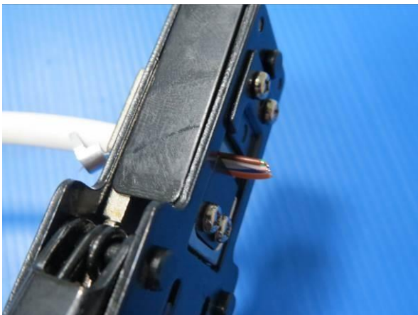
8. プラグをPM-3008R圧着工具に差し込み圧着します。
