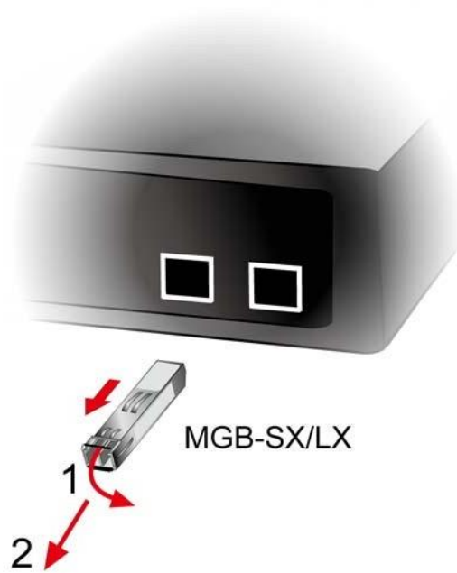
図 2-1-8 SFP トランシーバを引き出す方法
